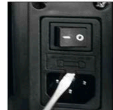
Abbildung 4: Lösen Sie die Hülse mit einem Flachsraubenzieher heraus.
